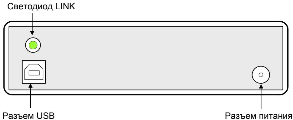
**Разъем USB** – тип Б. Стандартный разъем для подключения устройства к компьютеру по шине USB кабелем типа А-Б.
