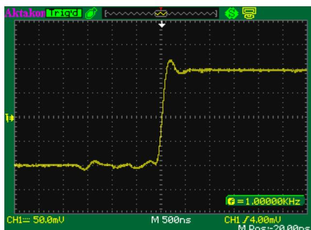
*работа нефильтрованного выхода на нагрузку 470 пФ.*
